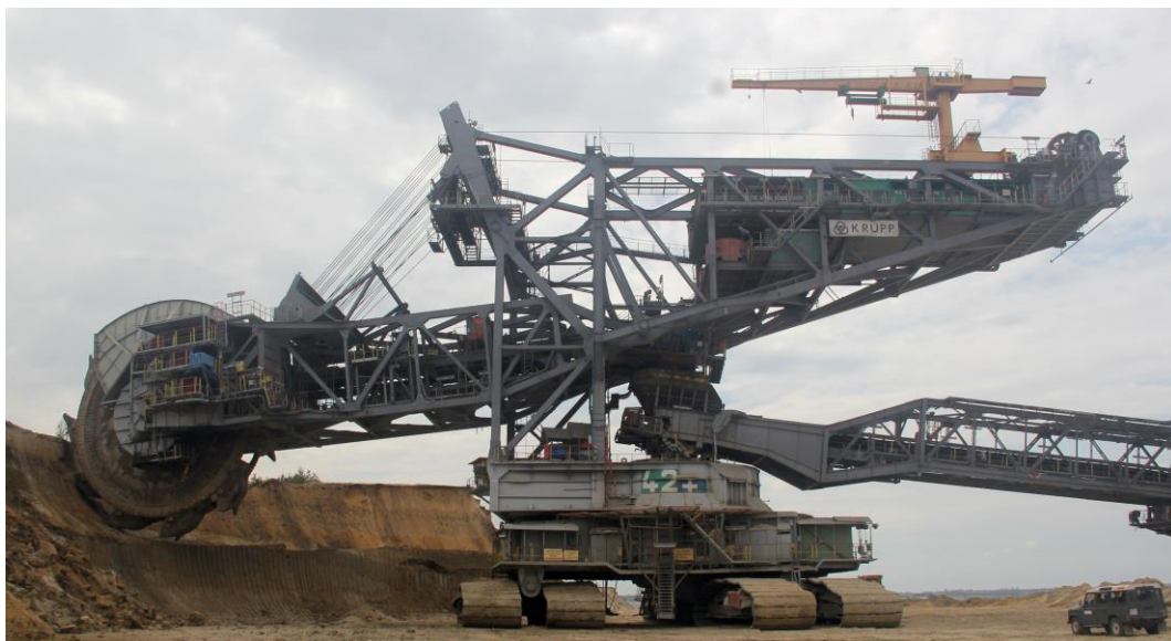
Fig. 1. Bucket-wheel excavator SchRs4600 of KRUPP
