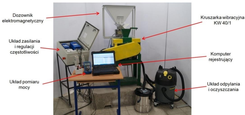
Rys. 1. Widok stanowiska laboratoryjnego wibracyjnej kruszarki szczękowej o oznaczeniu KW 40/1
