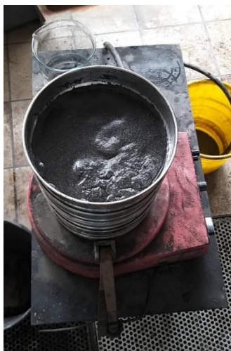
Rys. 8. Klasyfikacja ziarnowa na mokro z zastosowaniem przesiewacza wibracyjnego
